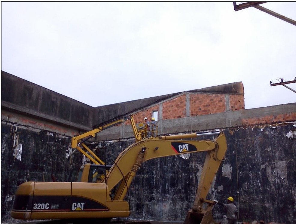
Foto 14 – Implementação para escavadeira – Içamento de Operários em gaiola adequada.
